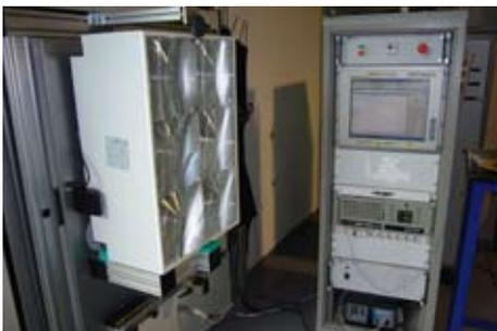
Equipos de caracterización de eficiencia de células y módulos solares
